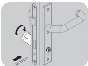
Afb. 19: Pro cilinder plaatsen
